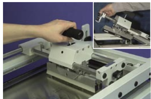
Die Rakelführung kontrolliert den Rakeldruck und den Winkel individuell für die Vor- und Rückbewegung. Durch die zentrische Aufhängung verteilt sich der Druck gleichmässig über die ganze Rakelbreite. Gummi- oder Metallrakel können verwendet werden.
